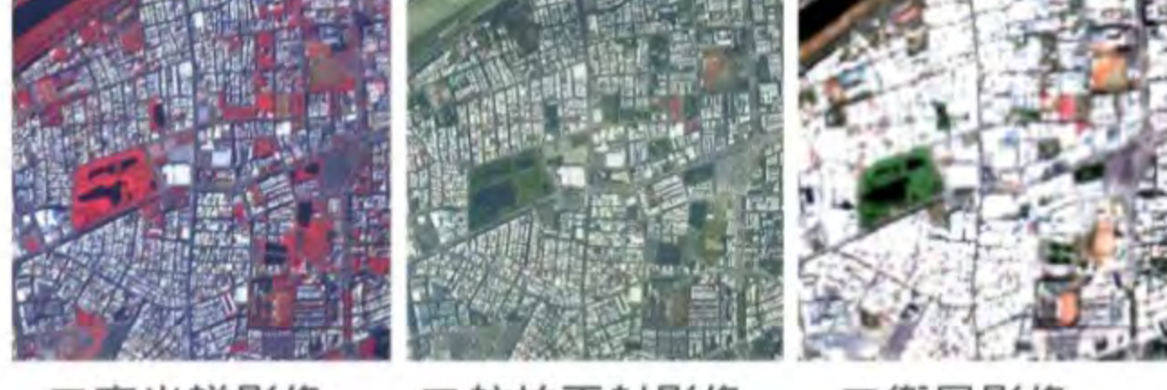
運用航遙測科技與相關影像圖資進行石綿屋瓦判釋
