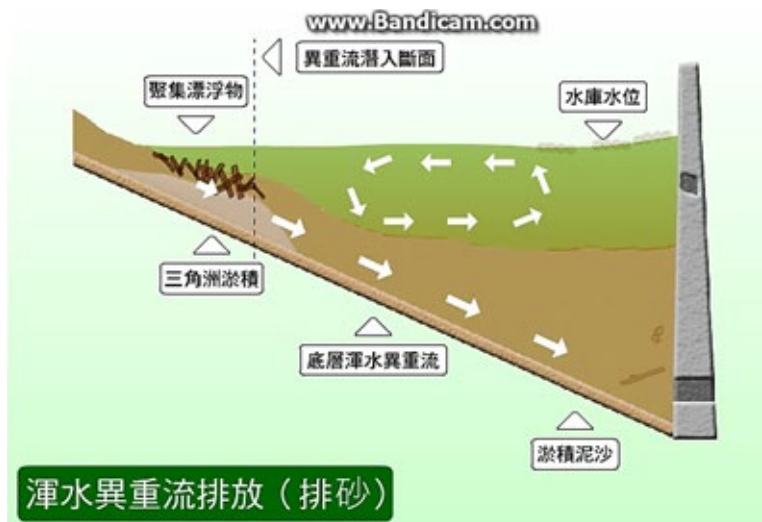
圖1 異重流於水庫內的流動和淤積物的分布圖
