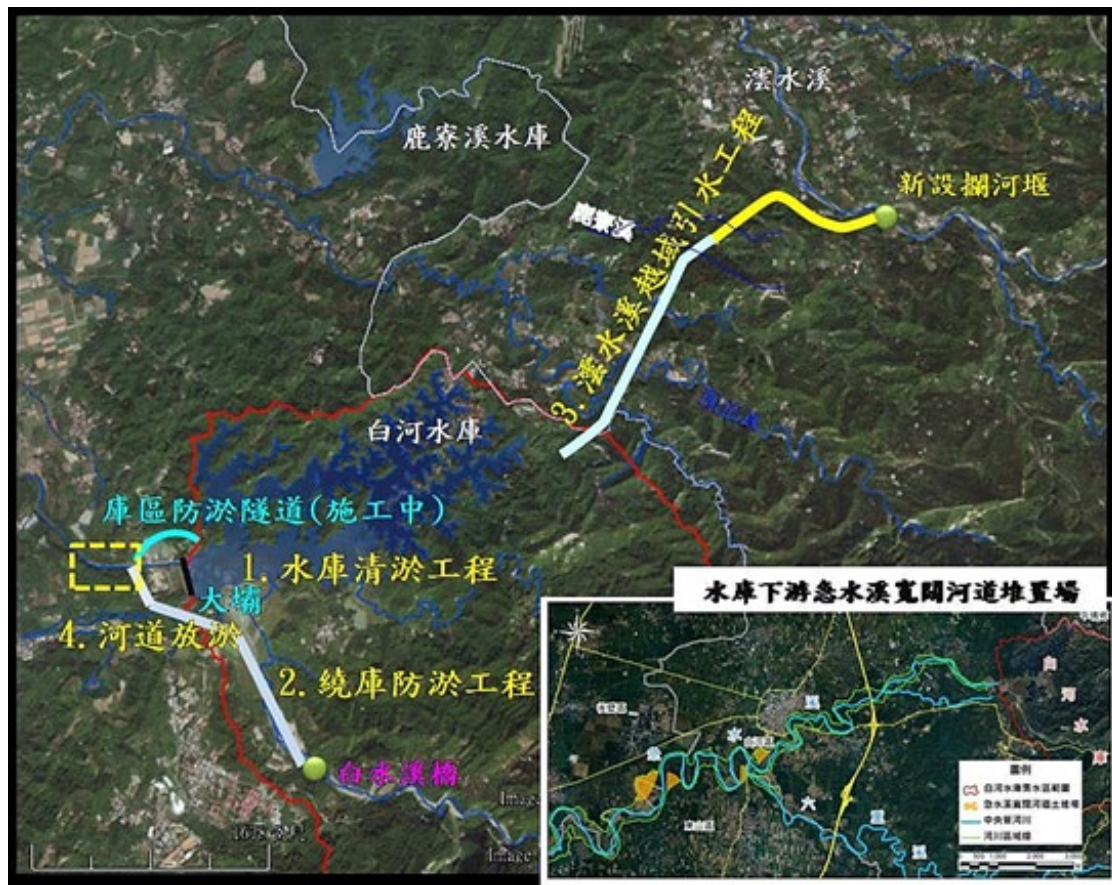
圖7 白水水庫繞庫防淤工程佈置圖
